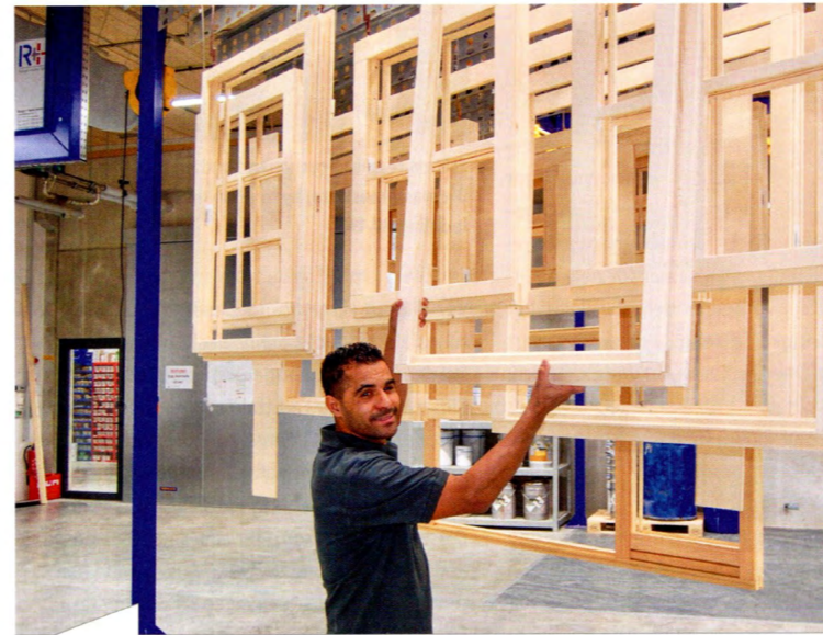
Der Leiter der Oberflächentechnik Lassad Soula, der mit der ersten Roboterlackieranlage nicht zuletzt auch die Chance zur persönlichen Weiterentwicklung nutzte, beim Aufhängen der Rahmentteile; dabei unterstützt ihn ergonomisch eine Hebe- und Senkvorrichtung.
