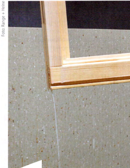
Wichtig: Nach der Imprägnierung werden die Traversen automatisch schräggestellt, um überzähliges Material abtropfen zu lassen. Laut Claudia Max-Heine lässt sich dieses bei sorgfältigem Umgang mit dem Abtropfbereich wiederverwerten, v. a. aber trägt ein optimiertes Abtropfverhalten zur Oberflächenqualität bei.
